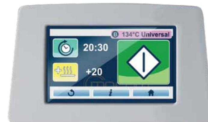
Concebido para optimizar el flujo de trabajo, la esterilizadora B Futura ofrece la posibilidad de programar el arranque de los ciclos de esterilización y de test en las franjas horarias más convenientes desde un punto de vista energético, para evitar la sobrecarga de la instalación eléctrica debida al uso simultáneo de varios dispositivos o simplemente para tener lista la esterilizadora al empezar la jornada de trabajo.
